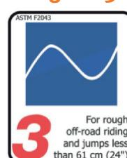
Bicicletele/accesoriile acestei categorii pot fi utilizate suplimentar la condițiile de utilizare menționate în categoriile 1 și 2 și și pe trasee abrupte, pe teren abrupt și pe distanțe dificile care necesită o bună tehnică de deplasare. Săriturile și drops pot apărea aici până la o înălțime de până la max. 61cm.
