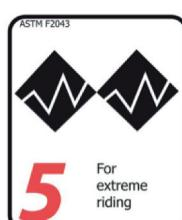
这一类的自行车/零部件除了可以满足第1、2、3、4类使用条件之外，还可以承受很大的弹跳、越野，时速最高可超过 40 km/h。但不包括土坡腾跃！
