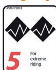
As bicicletas/acessórios desta categoria podem, adicionalmente às condições de utilização mencionadas nas Categorias 1, 2, 3 e 4, operar em saltos extremos e descidas em terreno acidentado a uma velocidade superior a 40 km/h.
