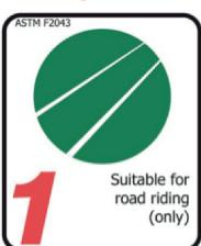
Cybler/monteringsdele i denne kategori bliver kun bevæget på asfalterede eller brostens-/flisebelagte gader og veje, hvor hjulene altid har kontakt med vejbanen.
