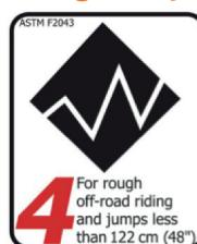
As bicicletas/acessórios desta categoria podem, adicionalmente às condições de utilização mencionadas nas Categorias 1, 2 e 3, operar em descidas em terreno acidentado a uma velocidade máxima de 40 km/h. Podem ser realizados saltos e drops de um altura máxima de 122cm.
