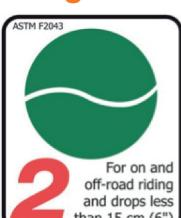
Les pièces/accessoires pour vélo de cette catégorie peuvent également être utilisés, en plus des conditions visées dans la catégorie 1, pour des chemins de terre ou de gravier dont la pente est modérée. Dans cette catégory, le pneu peut perdre momentanément le contact avec le sol lorsque le terrain est irrégulier. Des sauts (drops) d'une hauteur max. de 15 cm sont possibles.
