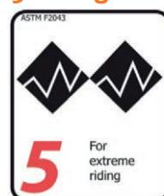
A kategóriába tartozó kerékpárt/szerelési részegységet az 1., 2., 3. és 4. kategóriában megnevezett felhasználási feltételek mellett extrém ugrásokhoz és durva terepről való lehajtásnál is használhatják, ahol 40 km/h feletti sebesség is előfordulhat. **A dirt jump (kerékpáros akrobatika) elnevezés felhasználási terület nincs szabályozva!**
