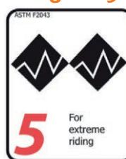
Fahrräder/Anbauteile dieser Kategorie können zusätzlich zu den in Kategorien 1, 2, 3 und 4 genannten Einsatzbedingungen auch für extreme Sprünge und Abfahrten in rauem Gelände bei Geschwindigkeiten über 40 km/h eingesetzt werden. **Nicht abgedeckt ist der Einsatzbereich Dirt Jump!**
