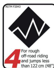
Fahrräder/Anbauteile dieser Kategorie können zusätzlich zu den in Kategorien 1, 2 und 3 genannten Einsatzbedingungen auch für Abfahrten in rauem Gelände bis zu einer Geschwindigkeit von max. 40 km/h eingesetzt werden. Sprünge und Drops können hier bis zu einer Höhe von max. 122cm vorkommen.
