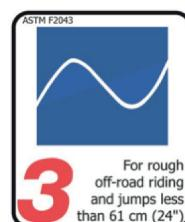
A kategóriába tartozó kerékpárt/szerelési részegységet az 1. és 2. kategóriában megnevezett felhasználási feltételek mellett durva nyomásávon, durva terepen és nehéz szakaszokon is használhatják, amely jó vezetési technikát igényel. Itt maximum 61 cm-es magasságból fordulhatnak elő ugrások és ejtések.
