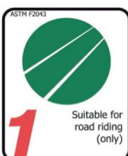
A kategóriába tartozó kerékpárt/szerelési részegységet kizárolag aszfaltozott vagy kövezett utcán és utakon használják, ahol a kerékek folyamatosan érintkeznek a talajjal.
