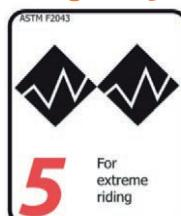
Les pièces/accessoires pour vélo de cette catégorie peuvent être utilisés, en plus des conditions visées dans les catégories 1, 2, 3 et 4, pour des sauts extrêmes et des descentes en terrain accidenté pour des vitesses supérieures à 40km/h. **Le domaine d'activité "Dirt Jump" n'est pas couvert par cette catégorie !**
