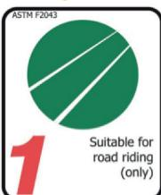
Les pièces/accessoires pour vélo de cette catégorie doivent être utilisés exclusivement pour des routes et des chemins goudronnés ou pavés. Les roues doivent être en contact permanent avec le sol.
